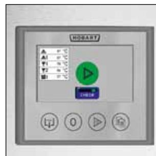
Visualizzazione del check-up del sistema BEST-START sul display interattivo a colori del comando PROTRONIC.
