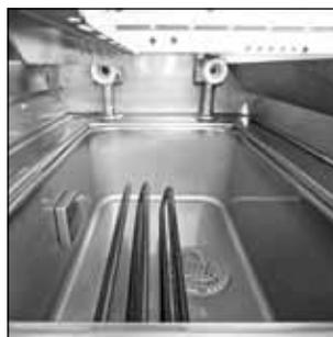
Il risciacquo ad acqua calda con pompa aumenta l'auto-asciugatura delle stoviglie.
